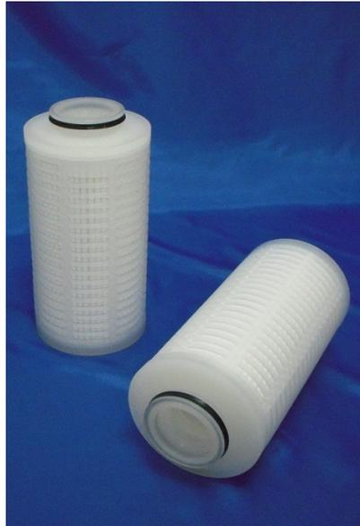
ポリプロピレン製ハイフローデブスプリーツフィルターです。フィルターメディア部に密度勾配を有している為、粒子径に合わせて各層で粒子を捕捉します。空隙率が大きくゲル状異物捕捉に有効です。10インチ1本当り100L/minの処理可能ですので、フィルター設備の小型化、作業時間の効率化を実現します。素材は極めて低溶出の為、食品、医薬品のアプリケーションにも安心してご使用頂けます。
